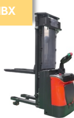
Gerbeur direction assistée 1,6 t – Levée 3,6 à 4,6 m
