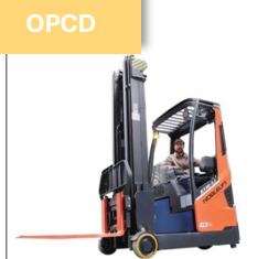
Chariot à mât rétractable 1,6 t – Levée 4,5 à 9,5 m
